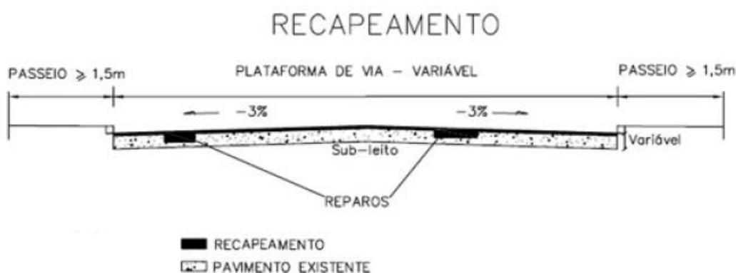
Figura 1 - Seção Tipo Recapeamento com Micro Revestimento e Tapa Buraco.
